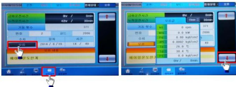
当设备停止运行时，控制器可能误认为发生故障，因此重启设备时有必要初始化，还有停电造成设备停止时，控制器可能会发生错误运行，请关闭控制器电源并初始化控制器。尤其是在远程运行模式下发生故障时，必须检查设备状态后重新启动设备。
