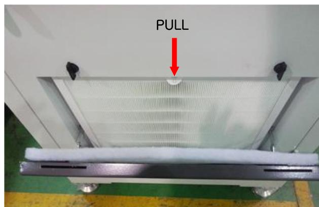
若为法兰式，则打开侧面吸入过滤器箱盖，拉出过滤器。
