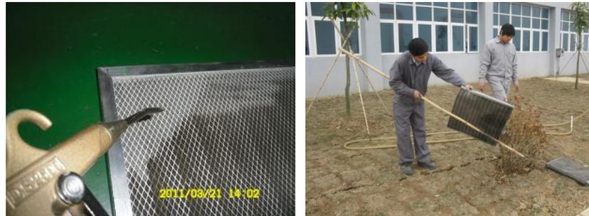
过滤器无法彻底隔离空气中异物。随着时间累积，粘附在过滤器表面的异物会慢慢通过过滤器渗入机器内部（见下图，红色标记代表异物）。因此需要定期清洁过滤器和机箱内部。
