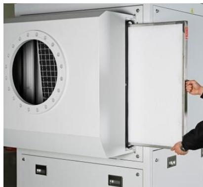
喷射压缩空气消除堆积灰尘。使用木棍用力敲打过滤器也可消除灰尘。这时彻底清洁过滤棉非常重要。
