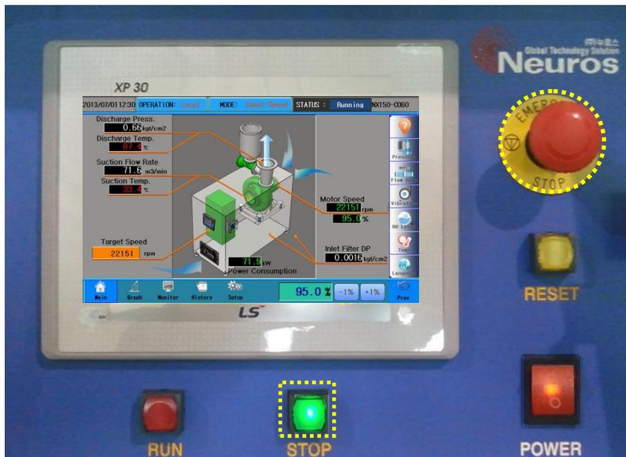
需要正常停机时，按下控制器的[停止]按钮。‘停止’按钮灯将亮起、同时放空阀自动打开，降低排放压力，并逐渐降低转速。(状态：‘停止中’)。
